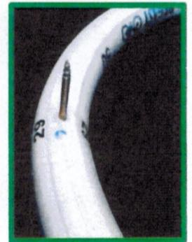
4. Beim Aufziehen des Collés auf die Felge ist darauf zu achten, dass das Ventil gerade steht und keinen Zug nach links oder rechts erhält. Die Kraftverteilung muss gleichmässig sein.
